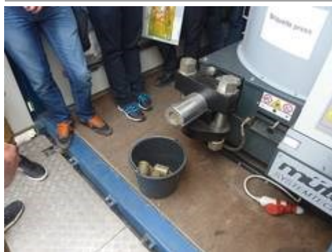
Tutte le fasi del processo della tecnologia IFBB sono mostrate in azione, qui la produzione die bricchetti da erbe.
